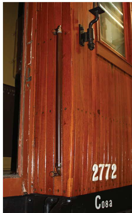
Nya ledstänger tillverkades av rör som laserades och fernissades för att efterlikna bakelit.
