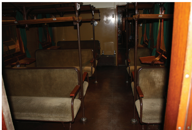
Soffornas tyg kunde bevaras genom mindre lagningar.
